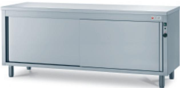
Gamma di tavoli scaldapiatti elettrici con lunghezza da cm 120 a cm 200, profondità cm 60 e 70. Sono dotati di doppia batteria riscaldante con resistenze elettriche carazzate, termostato di controllo (temp. +30/+90°C) e porte scorrevoli tamburate con ripiano intermedio. Piani di lavoro con o senza alzatina posteriore, realizzati con lamiera sp. 10/10.
